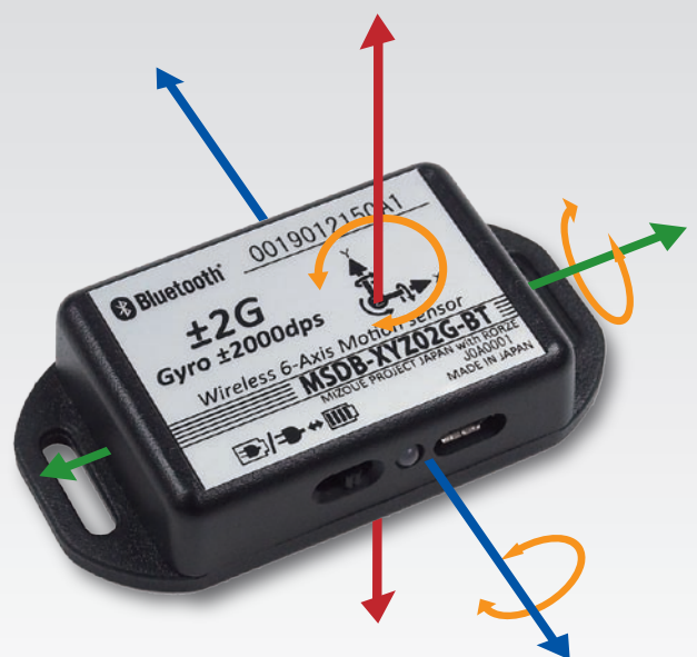
ワイヤレス 6 軸モーションセンサ ( \pm 2G, \pm 4G, \pm 8G, \pm 2000\text{deg/s} )
