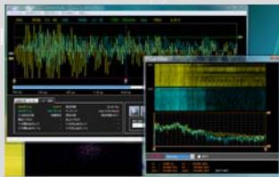
データ解析ソフトウェアは、DEBUGSCOPEの「データロギング機能」または「トリガ機能」でPCのハードディスクに取り込んだ波形データを再生します。データ解析ソフトウェアは、本体の接続に関係なくいつでも使用できます。
