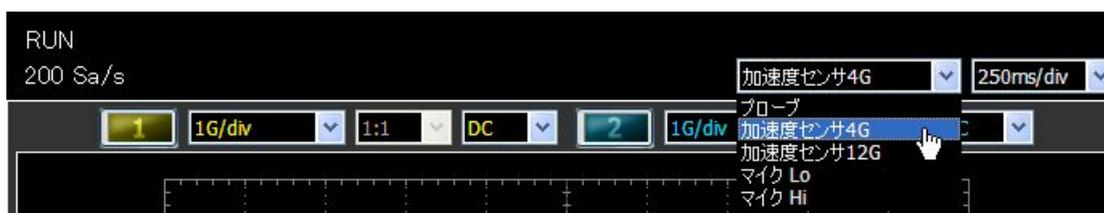
※加速度センサを使用する際、重力加速度による DC 成分を取り除きたい場合は、DEBUGSCOPE の入力カップリングを「AC」にしてください。
